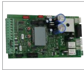
Centrale USER 1 - 24V DG programmabile con display a LED e luce di segnalazione integrati
