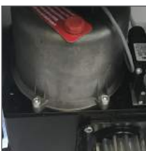
Lubrication in oil bath Lubricación en baño de aceite
