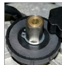
Mechanical twin-disc clutch Fricción mecánica bidisco
