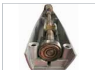
Vite senza fine supportata da cuscinetti
