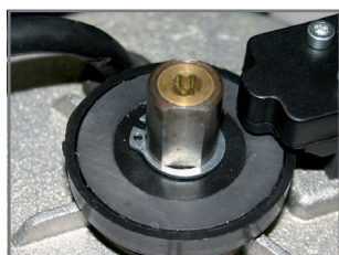
Frizione meccanica bidisco per regolazione della forza
