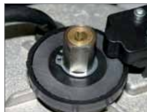
Frizione meccanica bidisco per regolazione della forza (solo per SATURN OIL)
