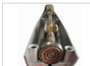
Vite senza fine supportata da cuscinetti
