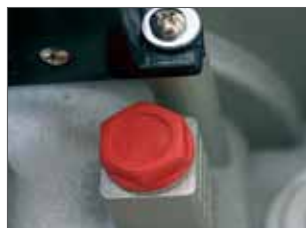
Lubrificazione degli ingranaggi in olio
