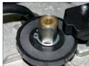
Frizione meccanica bidisco per regolazione della forza (solo per SATURN OIL)
