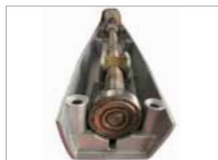
Vite senza fine supportata da cuscinetti
